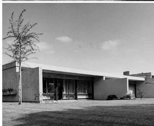
La réalisation de ce groupe de villas contiguës en tapis est probablement l'une des premières à Genève à être traitée de manière rigoureusement moderne, notamment par l'usage de matériaux tels que le béton armé brut ou par l'adoption de la toiture plate.
